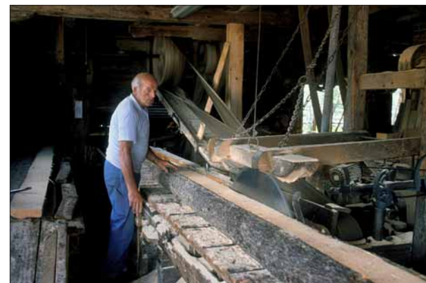
Sagen på Ænes er i dag turbindrevet. Her har det også tidligere stått en gammel oppgangssag. Bilete fra 1990.
