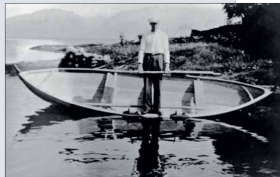
Båtbyggjar Magnus Tjå prøvar stabiliteten på den nybygde færingen.
